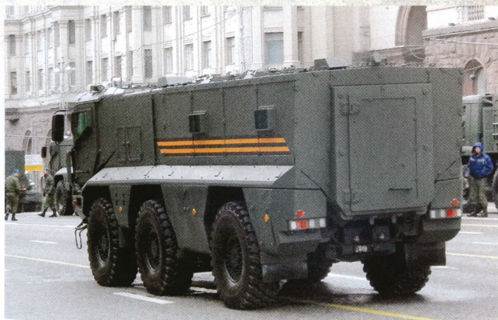
Броневедомитель «Тайфун-К», вид сзади слева. Хорошо видна кормовая дверь для посадки десанта.
