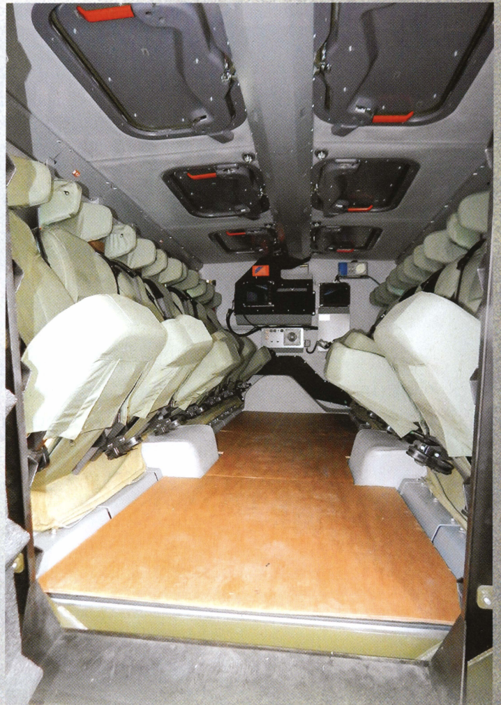
Общий вид броневого модуля броневедомобиля «Тайфун-К». Хорошо видны кресла для десанта вдоль бортов.
