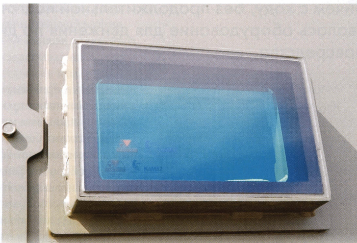
Установка блока с бронестеклом броневедомобиля «Тайфун-К».
