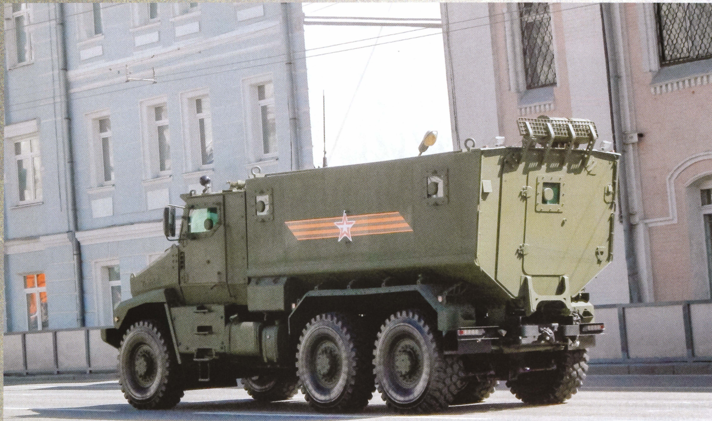
Бронеавтомобиль «Тайфун-У», вид сзади слева. В корме видна дверь для посадки десанта.
