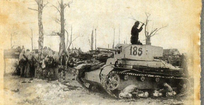
Экранированный Т-26 на позиции. Ленинградский фронт, февраль 1944 года. Дополнительные бронелисты установлены «по месту» при помощи гужонов и сварки.
